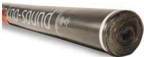
Es un bajo suelo acústico para pisos laminados o pisos de madera de ingeniería fabricado con polietileno reciclado de baja densidad que se utiliza para reducir la transmisión del ruido por impacto sobre las duelas de los pisos flotantes mencionados. También mejora considerablemente el aislamiento de la humedad de los firmes hacia el piso que se instala. Se presenta en bobinas de 2 mm de espesor que cubren un área de 10 m<sup>2</sup>/bobina.
